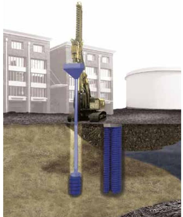
suelo circundante, genera una pre-tensión y una pre-deformación de la matriz del terreno, aumentando su densidad y resistencia .
